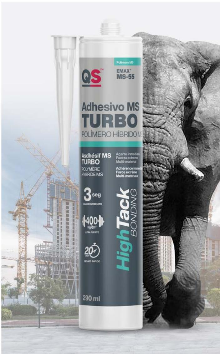
Adhesivo de tecnología híbrida MS, monocomponente, de agarre inmediato (3 seg.), extrafuerte (hasta 400 Kg/ dm<sup>2</sup>) y elástico, que alcanza rápidamente el rendimiento final, para el pegado de la mayoría de materiales (excepto PE. PP, PTFE, Teflón y Asfalto). Buena adherencia sobre superficies húmedas.
