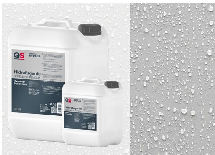
Hidrofugante en base silanos en dispersión acuosa para la aplicación sobre cerámica, tejas, hormigón, mortero, piedra, etc. Impermeabiliza y repele el agua. No forma película y es transpirable.
