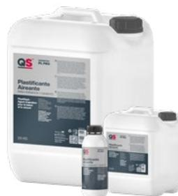
Aditivo líquido plastificante-aireante para confeccionar morteros y hormigones de gran docilidad y plasticidad, aumenta la cantidad de aire ocluido en morteros y hormigones, introduciendo pequeñas burbujas de aire de tamaño y espaciado controlado.
